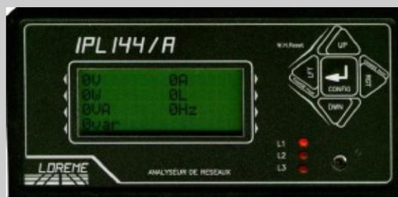
**L'IPL144 est un analyseur universel de réseau électrique. disposant de 8 emplacements (SLOTS) destiné à recevoir les interfaces d'entrées sorties (sortie analogique, liaison numérique, relais .....)**
